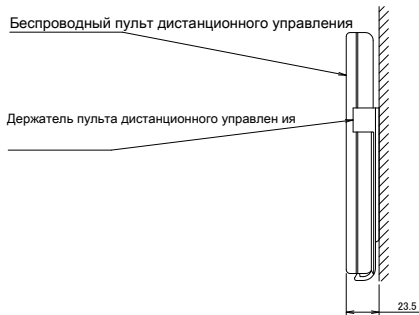
Монтаж на поверхности стены
